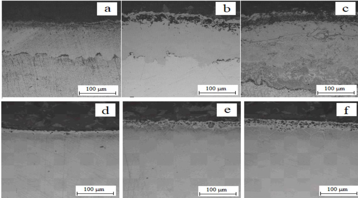
Figure 2. Optical micrographs of borided samples a) Ni-120 min. b) Ni-240 min. c) Ni-360 min. d) Ni40Al-120 min e) Ni40Al-240 min f) Ni40Al-360 min
