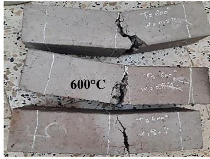
Figure 23. Exemple des poutres testées à 600°C
