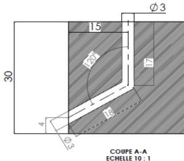
Figure 1. Parameters of the ECAP extrusion die
